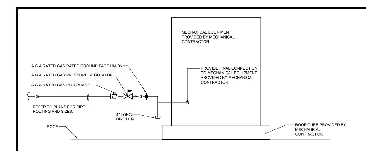
1 TYPICAL GAS EQUIPMENT CONNECTION DETAIL
